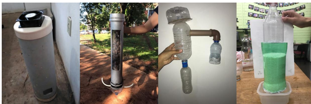
Anexo 1. a) Torre de resfriamento. b) Torre de absorção. c) Ciclone industrial. d) Torre de adsorção.
